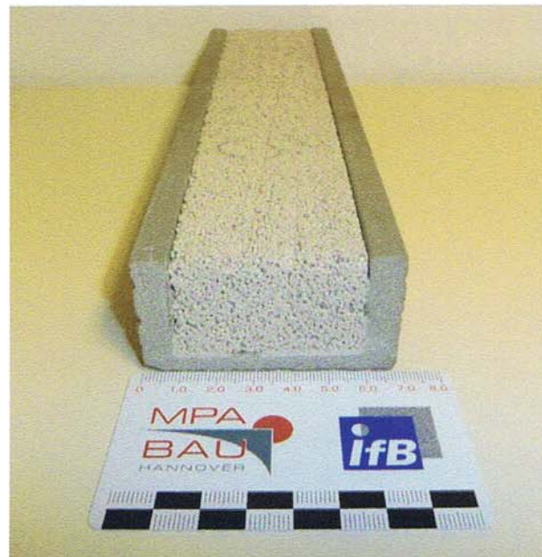
Bild 2: Schallabsorber aus Faserbeton mit gesintertem Blähglas
