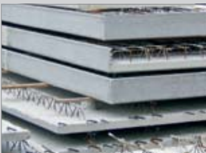
■ Optimální hrana balkónového prefabrikátu tvořená lemovým bedněním z vláknobetonu
