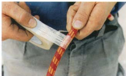
1. Ovinutí hadičky průhlednou lepicí páskou (Filamentband)
