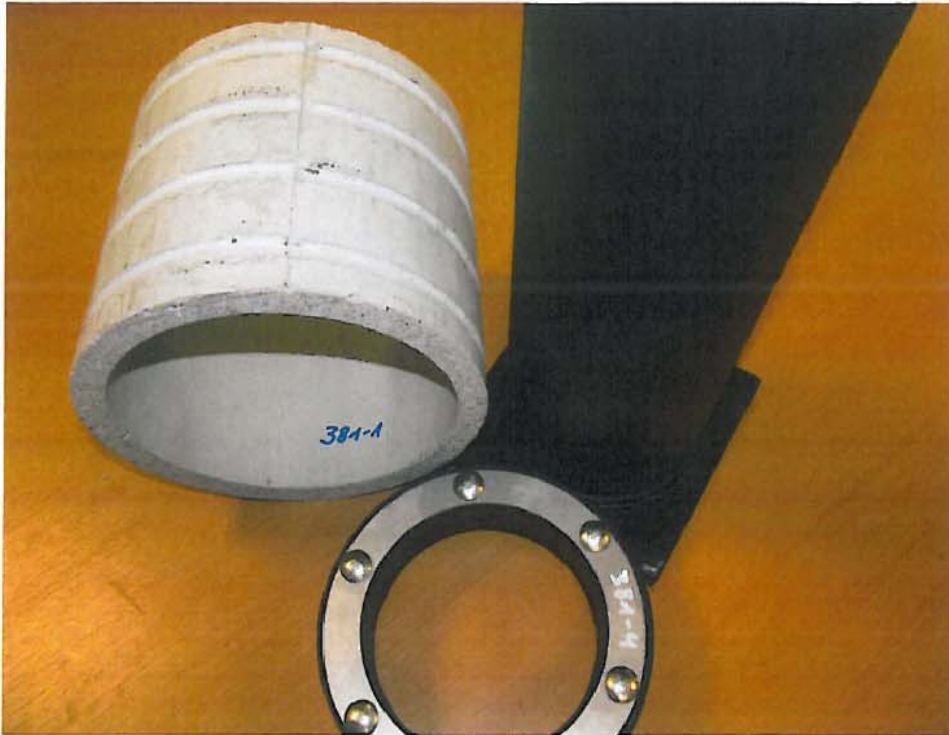
Obrázek 1: Vlákno-cementová roura Permur, těsnicí vložka Permur a PE-trubka s víkem
