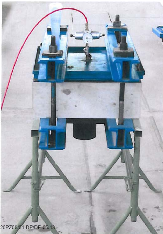
Obrázek 2: Zkušební těleso v průběhu tlakové zkoušky
